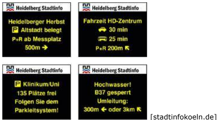
Abbildung 7: Einsatz freiprogrammierbarer Informationstafeln unterstützend zum PLS
