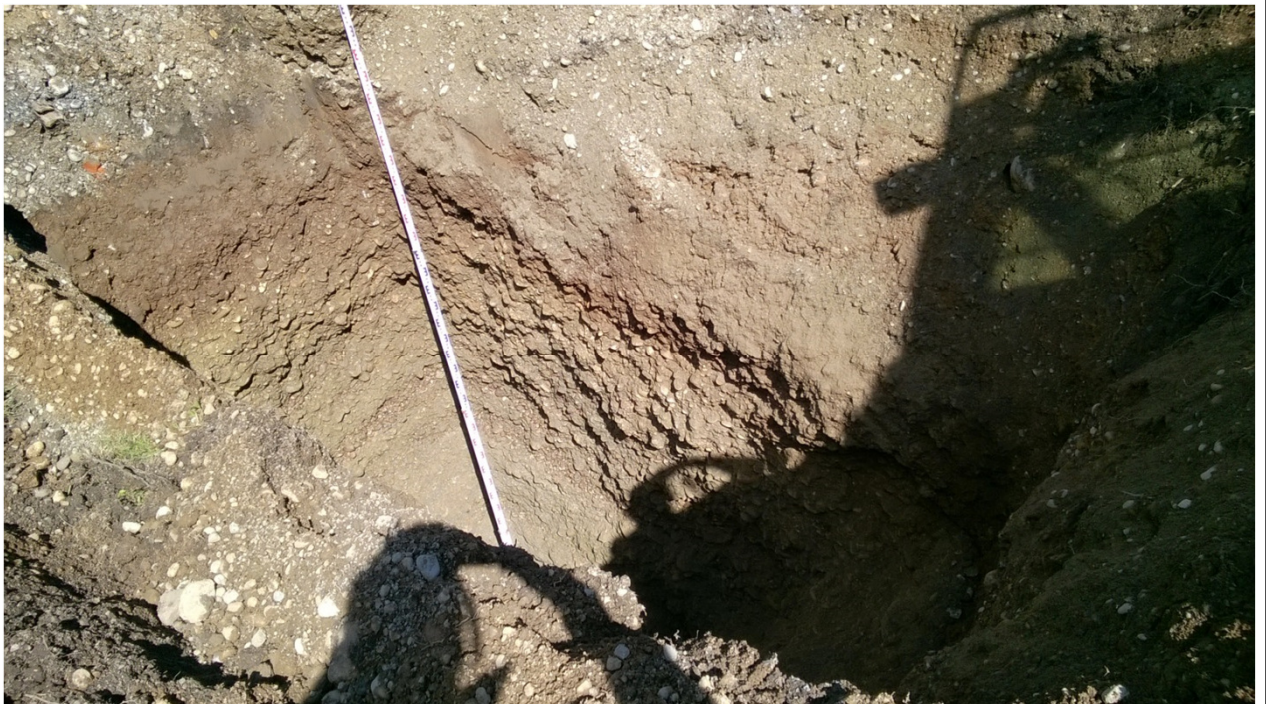
Bild 3. Schichtlagerung, Schurf Nr. SCH4(IV)
