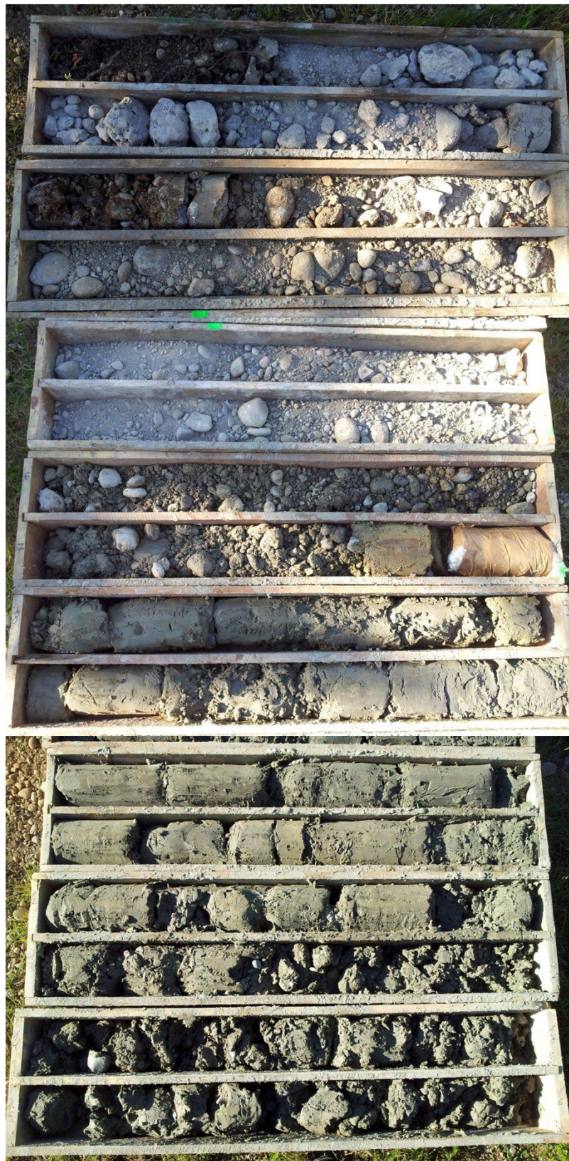
Bild 1. Bohrung B2 – Bohrprofil 0 – 16 m u. GOK
