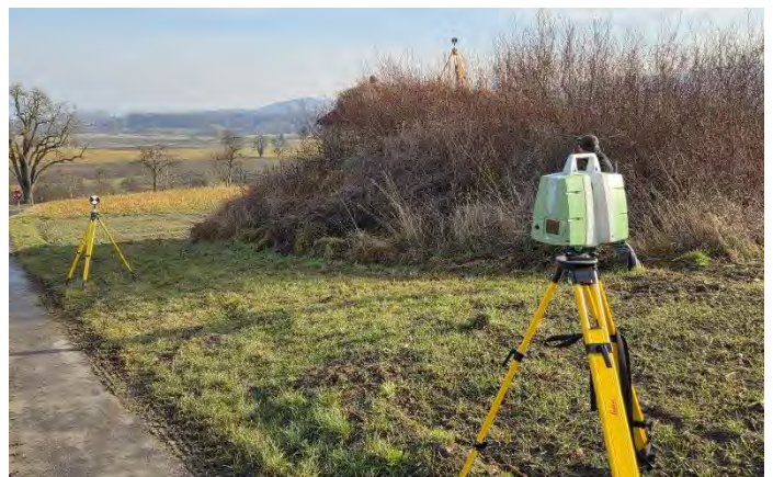
Ausmessen des Gebäudes und der Geländestruktur mittels Laser
