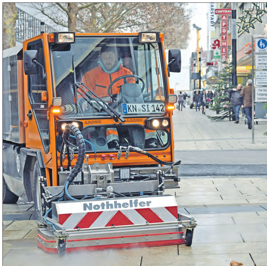
Ein neues Reinigungsfahrzeug wurde vor kurzem bei der Stadtreinigung in Betrieb genommen. Das Gerät, das auf den Namen Cleaner N15 hört, eignet sich bestens für die Reinigung von Fußgängerzonen, Parkhäusern, Ölspuren und Kunststoffbahnen auf Sportplätzen. Darüber hinaus entfernt es auch Kaugummis. Der Schmutzwasserbehälter fasst rund 1.500 Liter. In einer Stunde schafft es der Cleaner, rund 1.000 Quadratmeter Fläche zu reinigen. Dabei wird eine umweltfreundliche Reinigungsflüssigkeit und heißes Wasser mit einem Druck von bis zu 300 bar auf die Oberfläche aufgetragen und abgesaugt. Das Fahrzeug ist klein, wendig und kommt fast überall hin. Vier Mitarbeiter der Stadtreinigung sind mit dem neuen Reinigungsgerät unterwegs. Beim Fototermin saß Alexander Gross-Beschle am Steuer.
